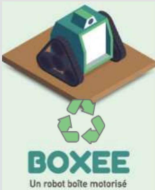
Le robot Boxee est un robot boîte qui avance jusqu'à ce qu'on l'arrête. Les jeunes vont travailler sur l'assemblage de leur robot, ce qui nécessite une certaine motricité fine afin de réussir à faire tenir les pièces ensemble. Il s'agira ensuite de réaliser le circuit électrique et de comprendre comment relier les deux moteurs au bloc pile de façon à ce que les deux moteurs tournent dans le même sens. Enfin, comme pour tous nos projets, la créativité a toute sa place dans ce projet.
